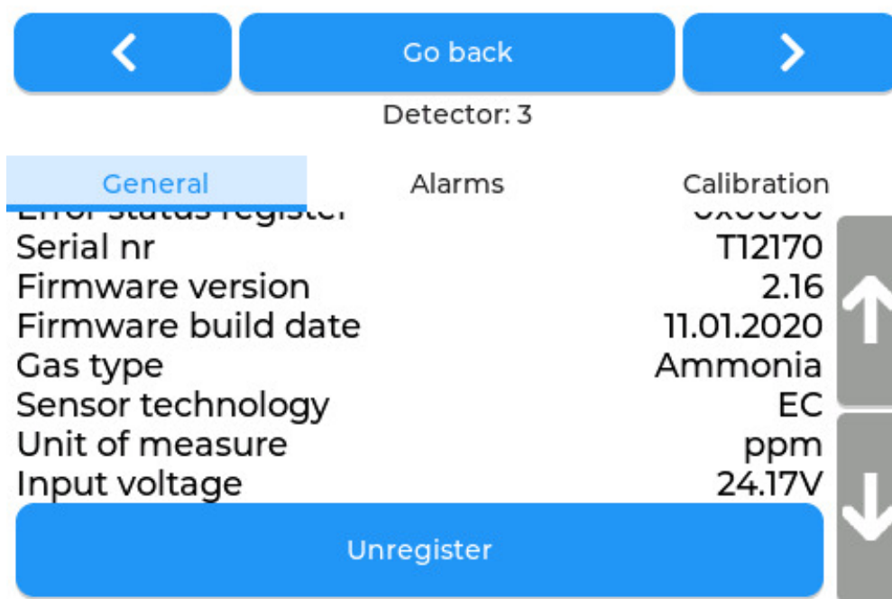
Rysunek 21: Ekran konfiguracyjny - zakładka "General" - część II
